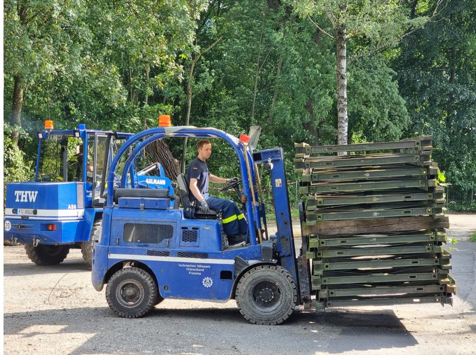
Alt. Aber kräftig! Super-wendiger Gabelstapler mit 3 to. Hubkraft unverzichtbar beim Laden von Brückenteilen
